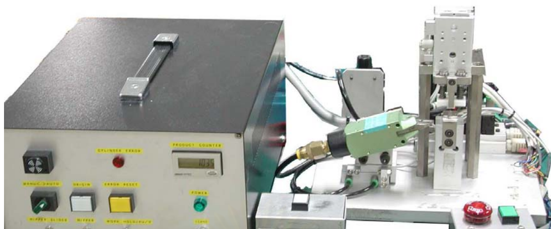
รูปที่ 5.18 แสดงเครื่องดัดและตัดขา IRD แบบอัตโนมัติ
