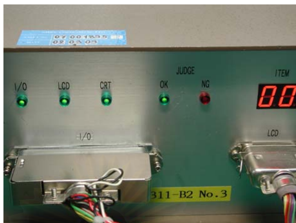
รูปที่ 5.47 แสดงสภาพของเครื่องเมื่อการตรวจสอบ OK
