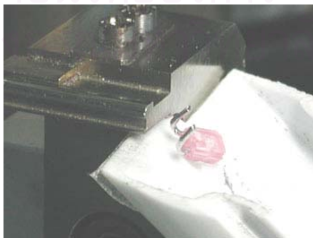
รูปที่ 5.33 เลื่อน IRD ที่ทำการตัดขาแล้วลงในรางข้างๆที่เตรียมไว้
