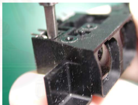
รูปที่ 5.40 แสดงการประกอบ IRD โดยใช้อุปกรณ์เสริมในการดัน IRD ให้เข้าไปให้สุดร่อง
