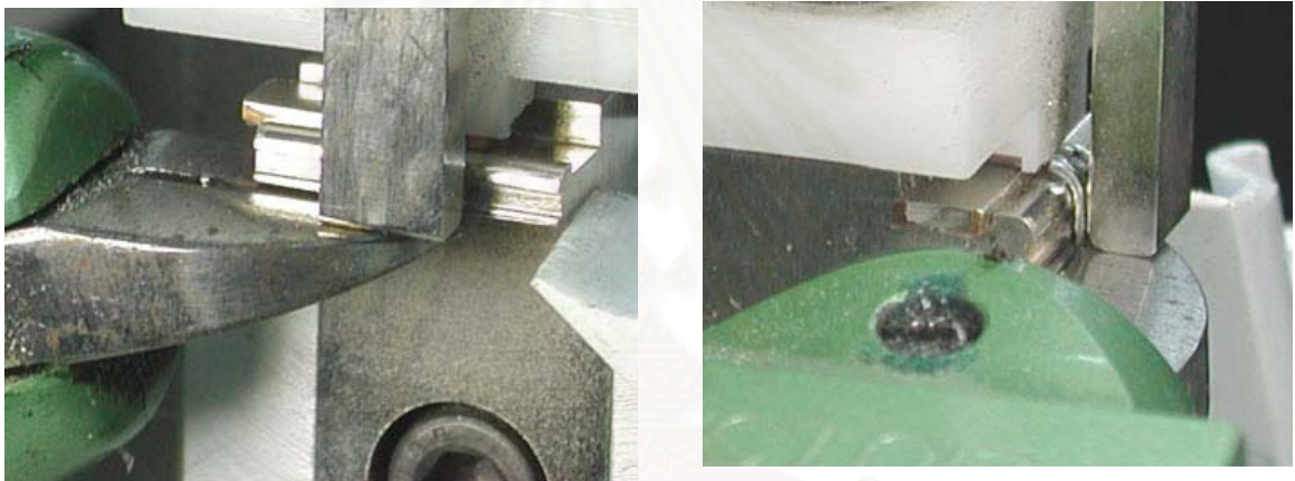
รูปที่ 5.29 แสดงการตัดขา IRD ของ Air Nipper
