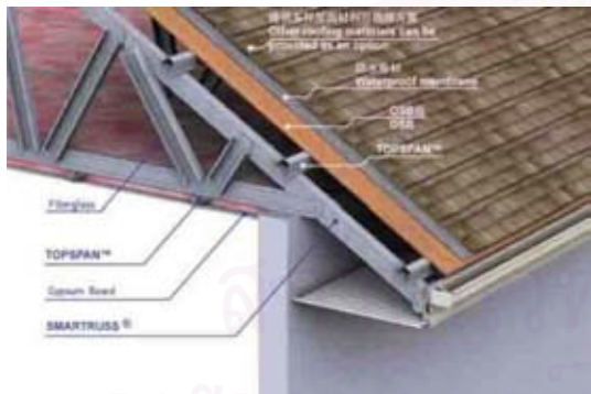
รูปที่ 4-112 ใช้วัสดุคุมหลังคาได้หลากหลายเหมือนบ้านที่โครงสร้างเหล็กทั่วไป
