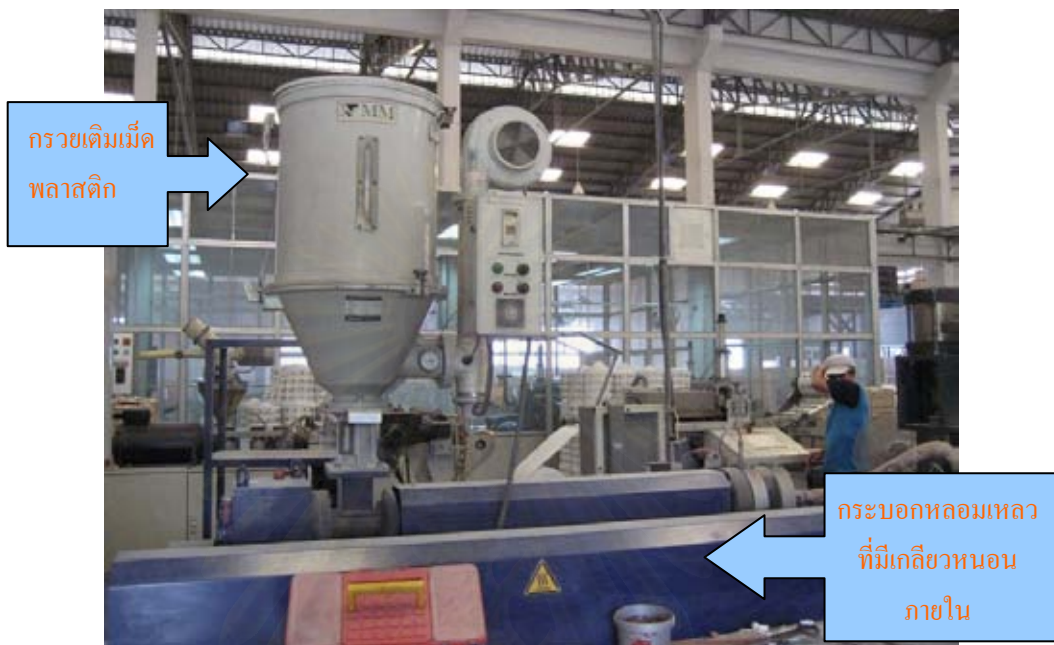
รูปที่ 6 เครื่อง Extruder ในกระบวนการรีด
