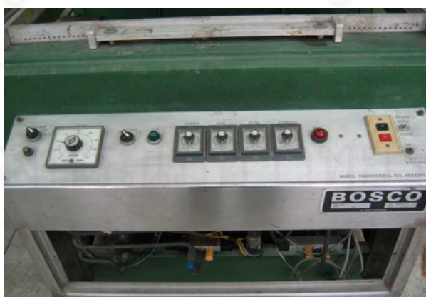
รูปที่ 5 แผงควบคุมของเครื่องขึ้นรูปร้อนด้วยสุญญากาศ
