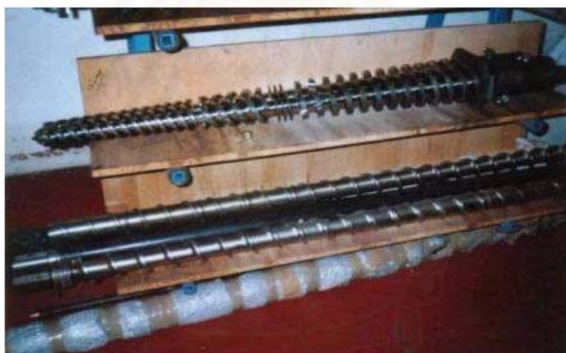
รูปที่ 6 แสดง เกลียวหนอนที่ใช้ในกระบวนการผลิต
