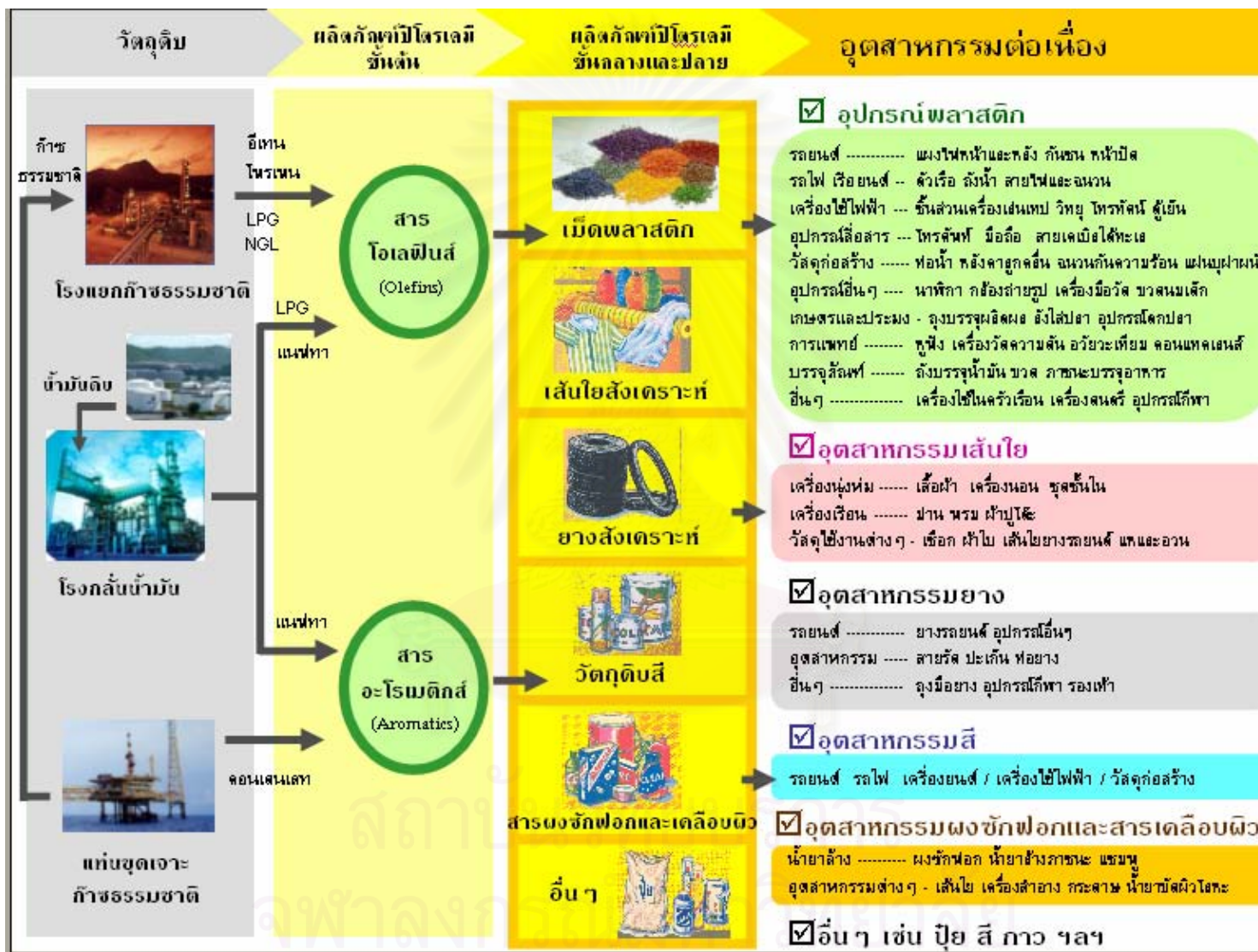
รูปที่ 4 แสดงกระบวนการผลิตพลาสติกตั้งแต่ต้นจนถึงการส่งผ่านไปยังอุตสาหกรรมต่างๆ
