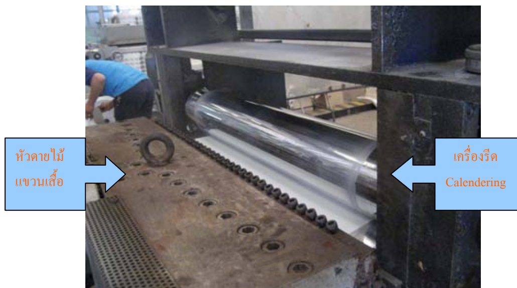
รูปที่ 7 แสดงการขึ้นรูปขั้นต้นด้วยกระบวนการ Extrusion
