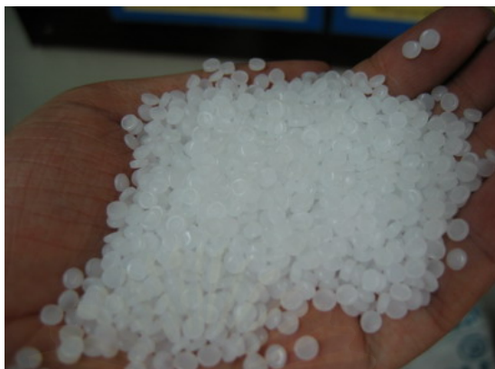
รูปที่ 1 แสดงลักษณะเม็ดที่นำมาขึ้นรูปเป็นแผ่นฟิล์ม
