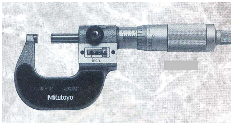
รูปที่ 4.3 แสดงรูปร่างของไมโครมิเตอร์วัดด้านนอก
