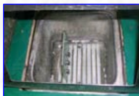
รูปที่ 4.10 แสดงเครื่องล้างชิ้นงาน
