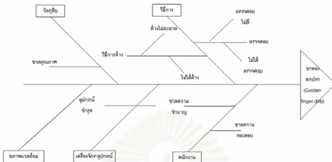
รูปที่ 4.6 แผนผังก้างปลาเพื่อวิเคราะห์หาสาเหตุของขาทองสกปรก (Golden finger dirty)
