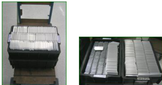
รูปที่ 4.9 แสดงถอดและการขนย้าย HSK เข้าสู่สายการผลิต
