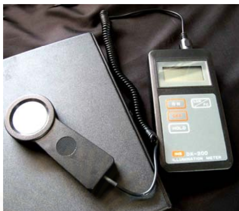
รูปที่ 3.2 แสดงเครื่องมือทดลองวัดความส่องสว่าง(Illuminance Meter)
