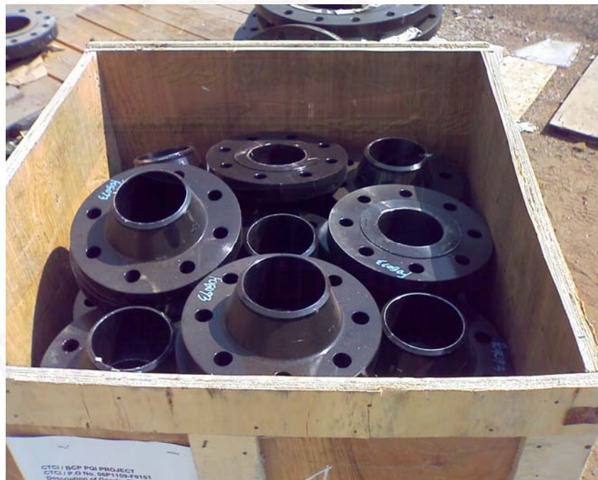
รูปที่ 3.5 ตัวอย่างหน้าแปลนใช้เป็นส่วนประกอบในงานระบบท่อ
