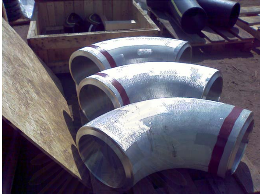
รูปที่ 3.6 ตัวอย่างข้อต่อท่อประเภทข้องอ 90° ใช้เป็นส่วนประกอบในงานระบบท่อ
