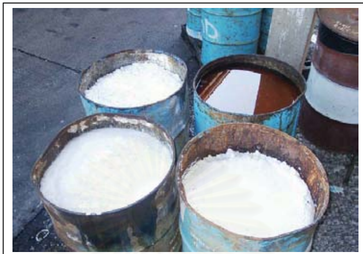
รูปที่ 1.1 แสดงลักษณะของ waste filter cake ที่ได้จากเครื่องกรองแบบใบ
