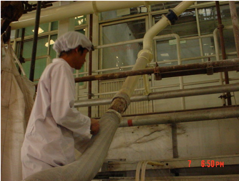
รูปที่ 3.7 เปลี่ยนท่อยึดหุ่นเพื่อต่อเข้ากับไซโคลน
