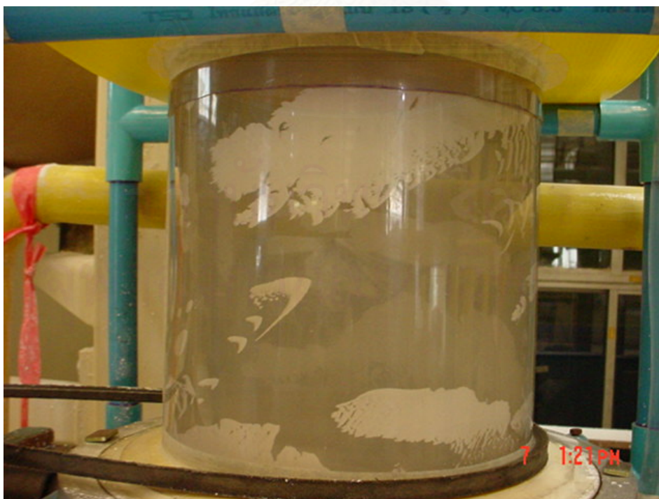
รูปที่ 4.6 แสดงปริมาณฝุ่นที่เกาะที่น้อยกว่าเมื่อตัวไซโคลนหมุน (เกาะบาง ๆ แต่เกาะทั่วไป)
