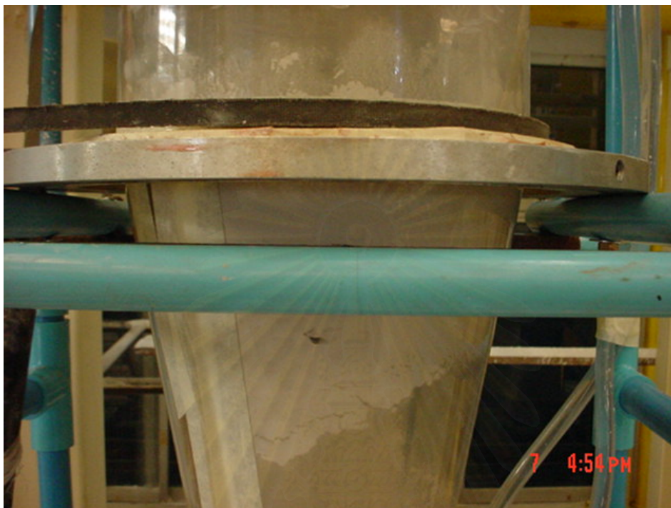
รูปที่ 4.5 แสดงฝุ่นที่เกาะบริเวณตัวไซโคลน (เกาะตัวตามแนวการไหลของ laminar flow)
