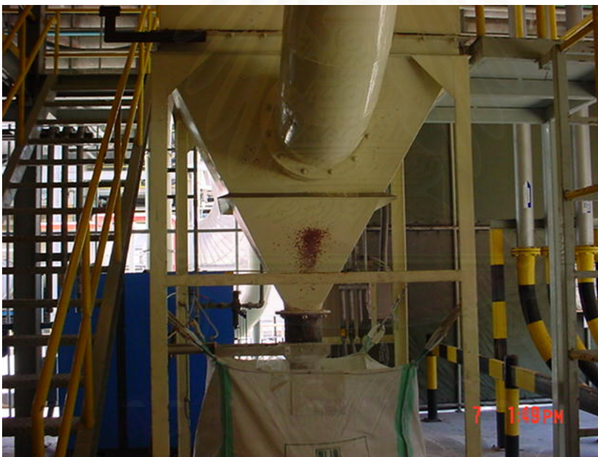
รูปที่ 1.4 ระบบลมดูดและ bag filter วัตถุดิบที่ใช้ระบบ manual มีดังนี้
