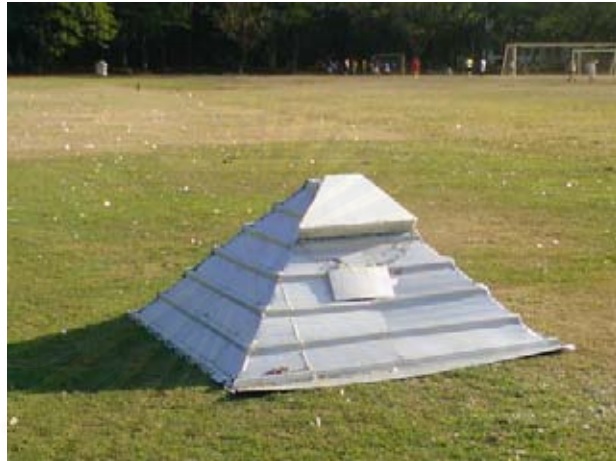
ภาพที่ 4.7 แสดงแบบจำลองรูปทรงปิระมิดผนังเหล็กเคลือบสังกะสี
