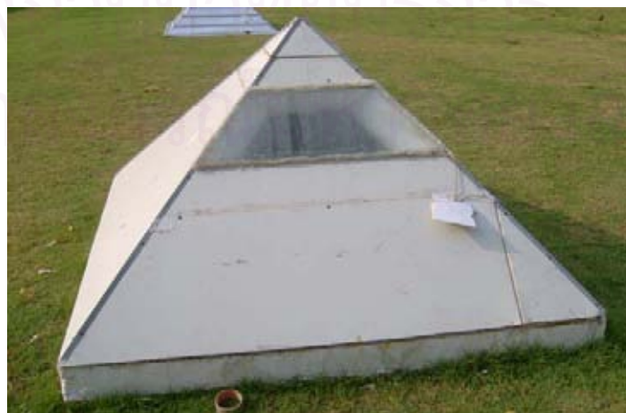
ภาพที่ 4.6 แสดงแบบจำลองรูปทรงปิระมิดผนังระบบฉนวน
