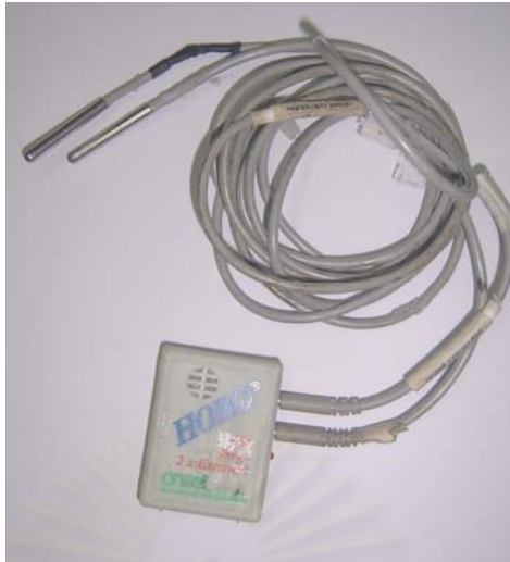
ภาพที่ 3.1 แสดงเครื่องมือเก็บข้อมูลอุณหภูมิ และความชื้นสัมพัทธ์
