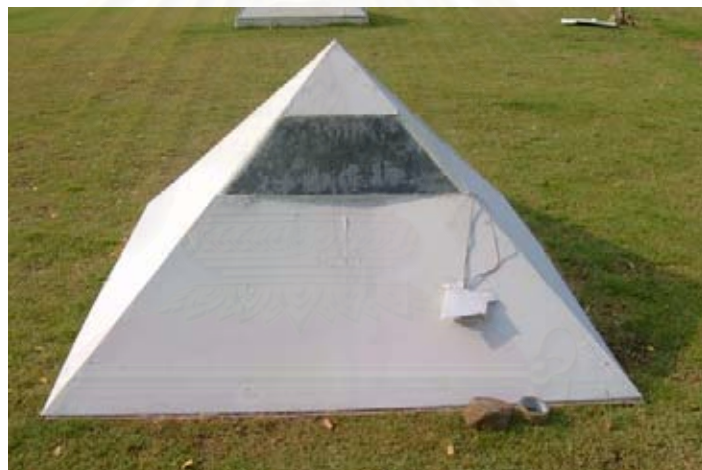
ภาพที่ 4.5 แสดงแบบจำลองรูปทรงปิระมิดผนังยิปซัมทาสี
