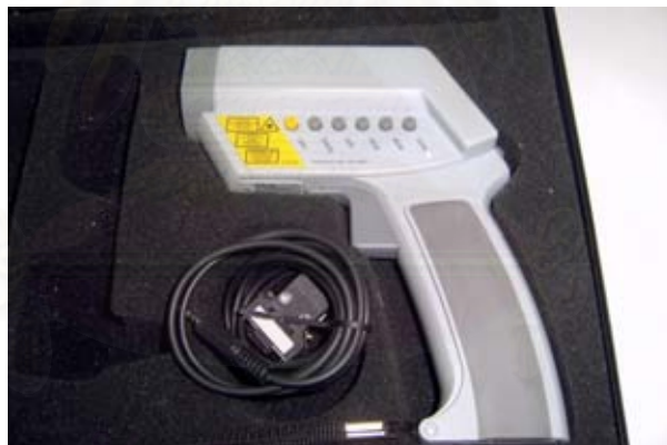
ภาพที่ 3.2 แสดงเครื่องมือเก็บข้อมูลอุณหภูมิพื้นผิว
