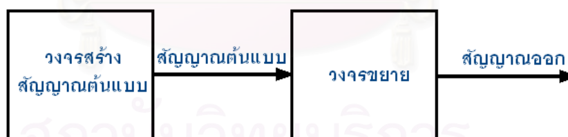
รูปที่ 2.3 โครงสร้างเครื่องจ่ายพลังงานแบบไม่มีการป้อนกลับ
