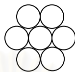
รูปที่ 4.1 การตีเกลียวตัวนำตีเกลียวแบบไม่อัดแน่น ชั้น 7 เส้น
