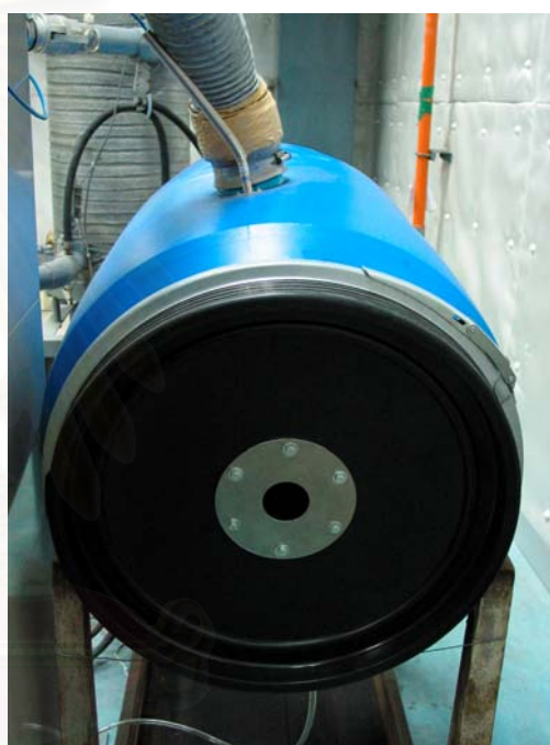
รูปที่ 4-7 แสดงถึงอากาศติดแผ่น orifice ที่ใช้อัตราการไหลของอากาศ
