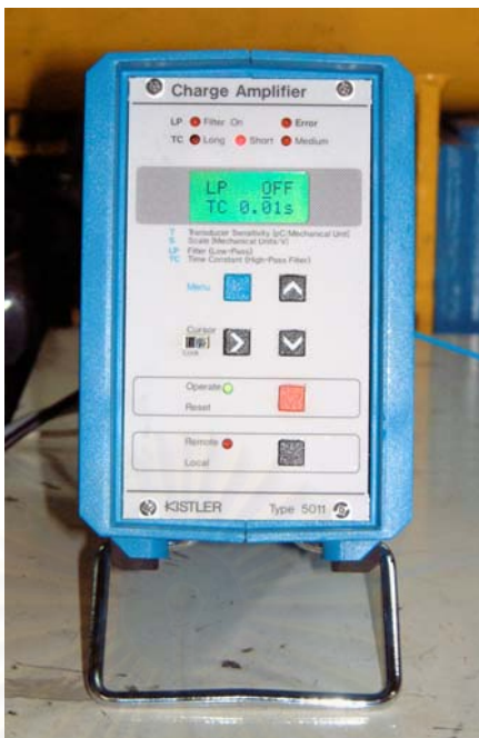
รูปที่ 4-17 แสดงภาพของ Charge Amplifier ยี่ห้อ KISTLER รุ่น 5011b11
