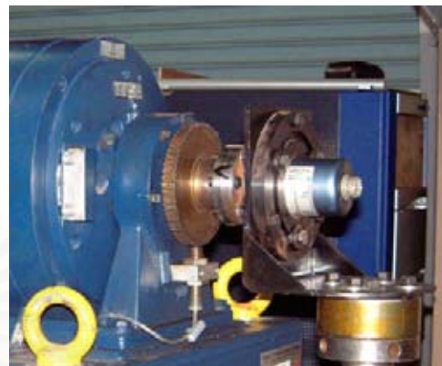
รูปที่ 4-13 แสดงภาพของ Shaft Encoder ยี่ห้อ Cussons รุ่น P4503
