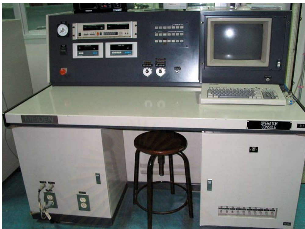
รูปที่ 4-5 แสดงภาพแผงควบคุมไดนาโมมิเตอร์
