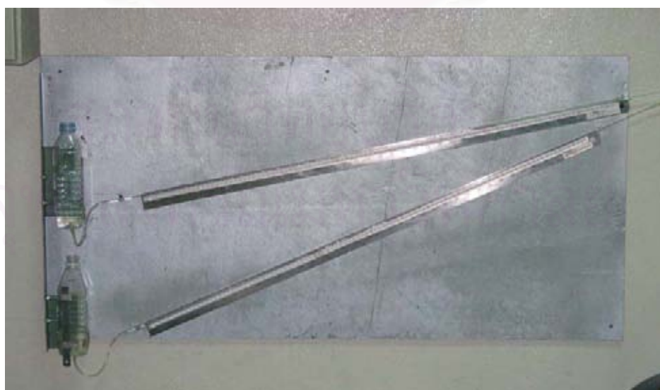
รูปที่ 4-9 แสดงमानอมิเตอร์ที่ใช้วัดอัตราการไหลของอากาศและความดันท่อไอดี
