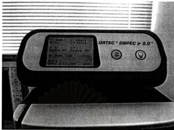
รูปที่ 3.5 เครื่องวิเคราะห์สัญญาณแบบหลายช่อง (Multi Chanel Analyzer ; MCA) (ของบริษัท ORTEC)
