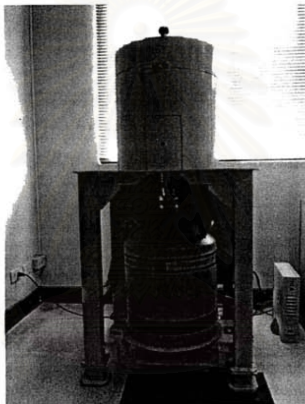
รูปที่ 3.4 หัววัดเจอร์มาเนียมความบริสุทธิ์สูงที่ใช้ในการวัดรังสีแกมมา พร้อมกำบังรังสี
