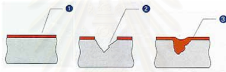
รูปที่ 2.2 การเกิด Passive layer ของ stainless steel
