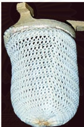
รูปที่ 1.5 ตะเกียงและไส้ตะเกียงเจ้าพายุที่มีส่วนผสมของทอเรียม
