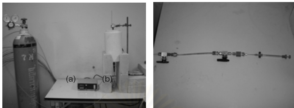
รูปที่ ค.17 ภาพการทดลอง (a) ส่วนการแก๊สซิปเคชั่น และ (b) ส่วนเก็บตัวอย่างก๊าซผลิตภัณฑ์
