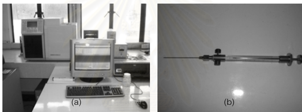
รูปที่ ค.18 เครื่องมือวิเคราะห์ก๊าซผลิตภัณฑ์ (a) เครื่องแก๊สโครมาโตกราฟี (GC) และ (b) syringe เก็บก๊าซผลิตภัณฑ์
