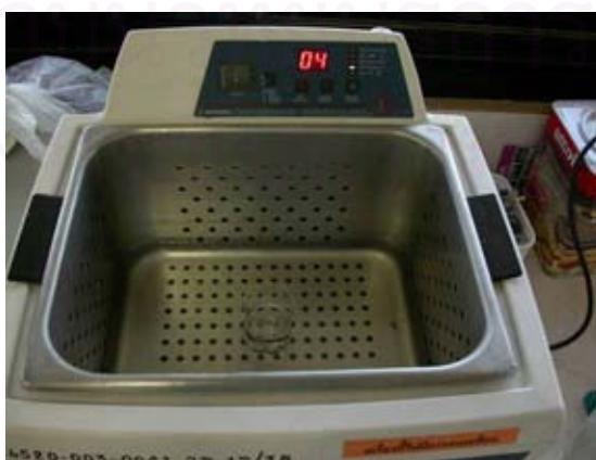
รูปที่ 22 แสดงการทำความสะอาดชิ้นงานด้วยเครื่องทำความสะอาดความถี่เหนือเสียง
