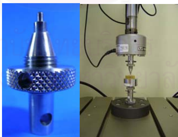
รูปที่25 แสดงการทดสอบแรงอัดในแนวตั้งด้วยเครื่องทดสอบสากล (Instron Universal testing machine)
