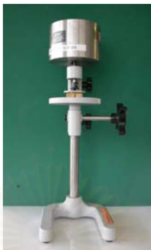
รูปที่24 แสดงการยึดชิ้นงานด้วยเครื่องทดสอบความแข็งแรงวัสดุที่มีตุ้มน้ำหนัก 5 กิโลกรัม
