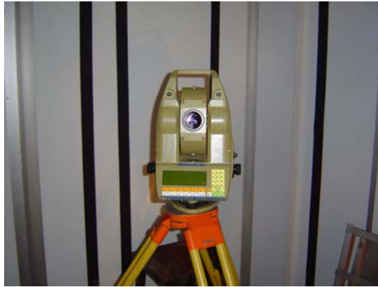
รูปที่ ๓ กล้อง theodolite รุ่น TC 1700
