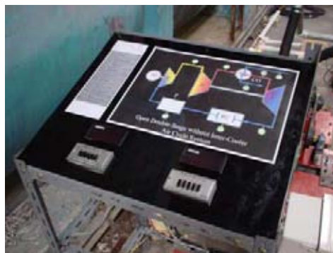
รูปที่ 4.36 แท่นควบคุม: แผงแสดงผลและเลือกช่องสัญญาณอุณหภูมิ
