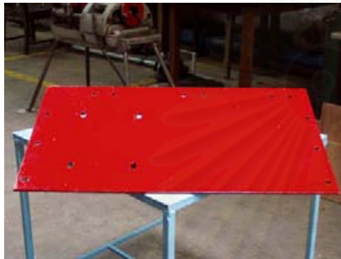
ก.) แท่น1 รองรับมอเตอร์ขับเคลื่อนเครื่องอัดอากาศ
