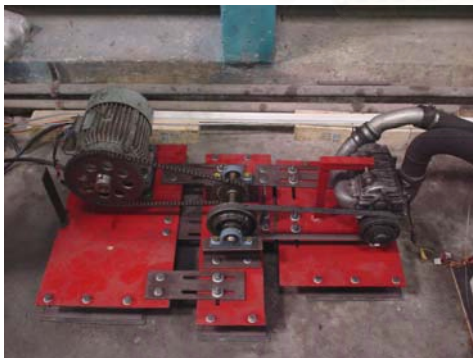
รูปที่ 4.30 ชุดทดสอบ ชุดขับเครื่องอัดอากาศ ประกอบเสร็จ
