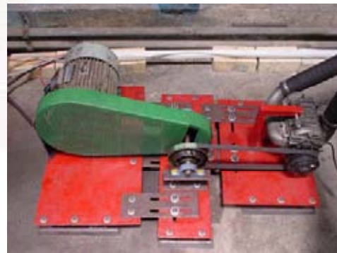
รูปที่ 4.31 ชุดทดสอบ ชุดขับเครื่องอัดอากาศ ประกอบเสร็จพร้อมกำบัง
