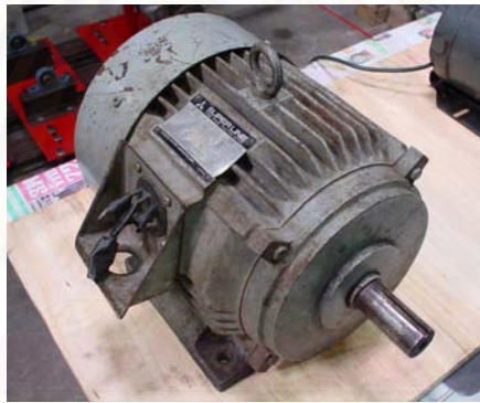
รูปที่ 4.7 มอเตอร์ขับเคลื่อนเครื่องอัดอากาศ
