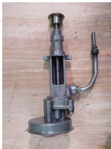
รูปที่ 4.6 ปั้มน้ำมันหล่อเพลาคู่มืออัด/ขยายอากาศ
