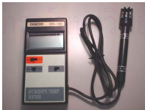
รูปที่ 4.17 เครื่องมือวัดความชื้นสัมพัทธ์อากาศ
