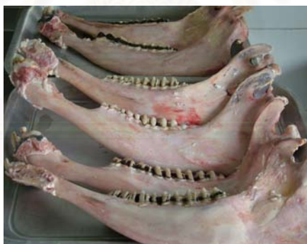
รูปที่ 4 แสดงกระดูกขากรรไกรล่างวัวที่ทำความสะอาดเรียบร้อยแล้วก่อนนำไปตัดเป็นชิ้นทดสอบ
