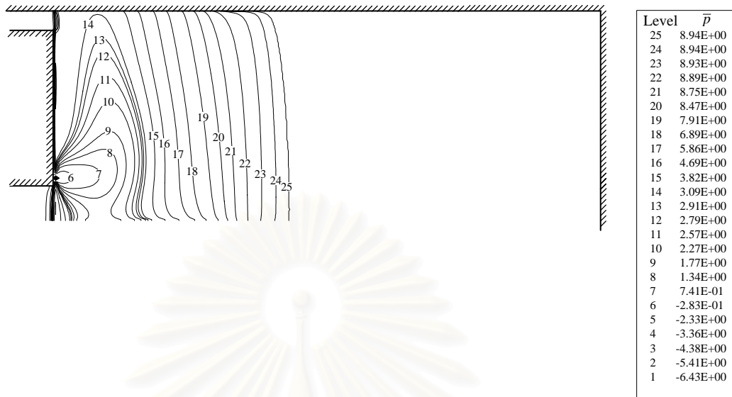
รูปที่ 5.114 ลักษณะการกระจายความดันของปัญหาการไหล Confined jet ภายในท่อปิด ที่ Re = 1.5 \times 10^5 ( \alpha = 0.195 , \beta = 0.22 และ \xi = 7.7 ) ด้วยแบบจำลองความปั่นป่วน High-Re k-\varepsilon-\gamma
