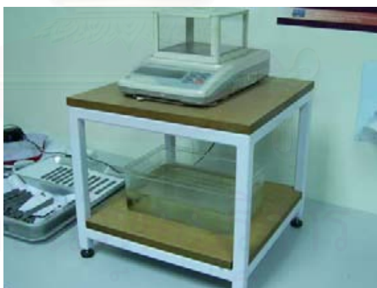
รูปที่ 3.4 ชุดวัดค่าความหนาแน่นของชิ้นงานหลังทำการเผาผืนิก
