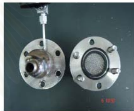
รูปที่ 3.2 ชุดทดสอบค่าการซึมผ่านของแก๊สแบบความดันคงที่
