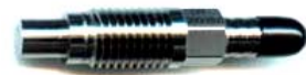
รูปที่ 4-25 แสดงภาพของ Pressure Transducer สำหรับวัดความดันเชื้อเพลิงที่ทางเข้าหัวฉีด
