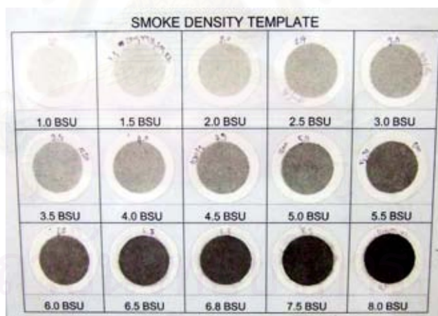
รูปที่ 4-19 แสดงตัวอย่างกระดาษกรองที่ใช้ในการวัดค่าควันดำเปรียบเทียบกับ Bosch Unit Number
