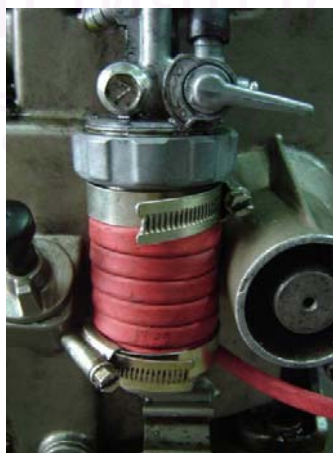
รูปที่ 4-23 แสดงการติดตั้งฮีตเตอร์แบบสายไฟเข้ากับถ้วยกรองโลหะในขณะใช้งาน
