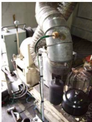
รูปที่ 4-35 แสดงหัวดูดไอเสีย ยี่ห้อ Sokken
