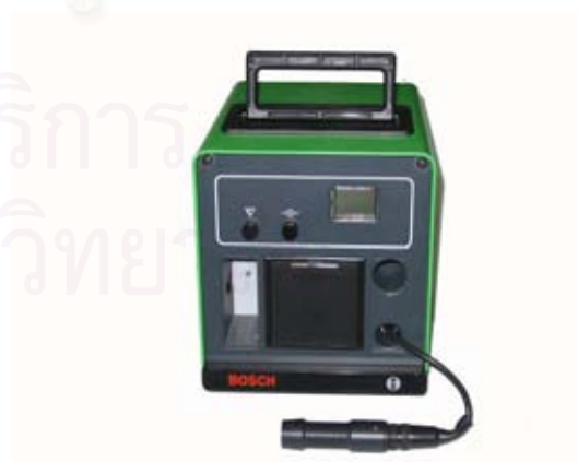
รูปที่ 4-18 แสดงเครื่องอ่านค่าควันดำ รุ่น ETD 020.50
