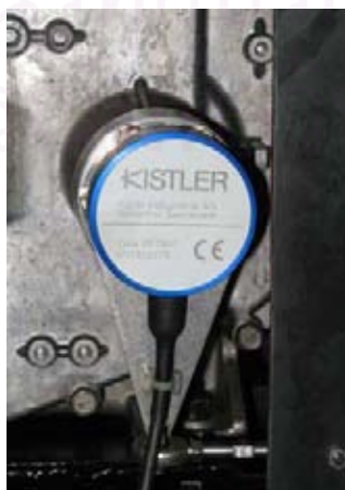
รูปที่ 4-29 แสดง Crank Angle Encoder ยี่ห้อ Kistler รุ่น 2613B
