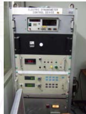
รูปที่ 4-34 แสดงชุดควบคุม ยี่ห้อ Tokyokoki Schenck
