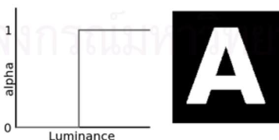
รูปที่ 2.25: การแยกภาพฉากหลังออกโดยใช้ขอบเขตความสว่างเดียว
