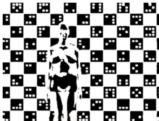
รูปที่ 3.10: ภาพที่ใช้ขีดแบ่งแบบปรับตัวได้ และผ่านการเพิ่มขนาดจุด
