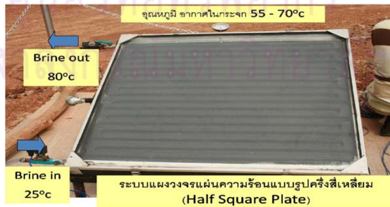
รูปที่ 3.14 แสดงแผนผังระบบวงจรแผ่นความร้อนแบบรูปครึ่งสี่เหลี่ยม (Half Square Plate)
