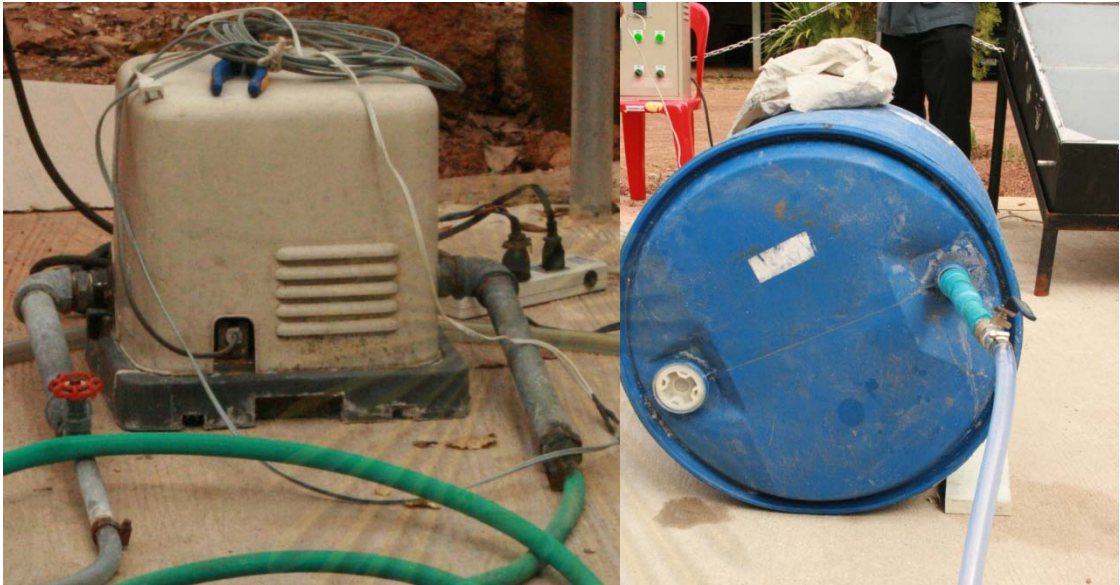
รูปที่ 3.11 น้ำเกลือที่จะนำมาทดลองเตรียมจะถูกดูดเข้าโดยอัตโนมัติ
