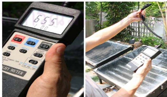
รูปที่ 3.7 เครื่องมือวัดความเข้มแสงที่นำมาใช้ทดลอง
