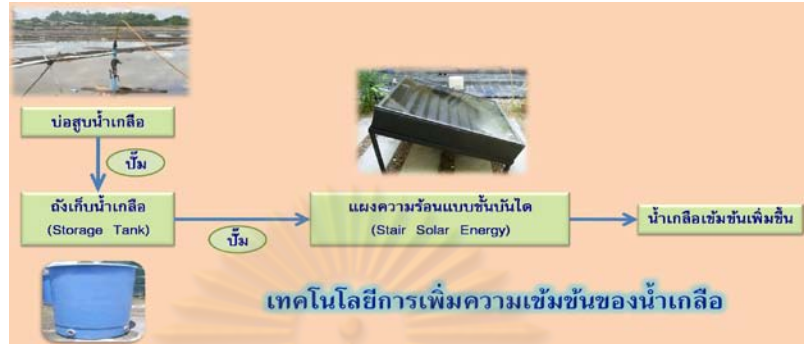
รูปที่ 3.19 แนวทางการนำระบบเพิ่มความเข้มข้นให้กับน้ำเกลือโดยใช้หัวสเปรย์ไหลเวียนแบบขั้นบันไดไปประยุกต์ใช้เพิ่มความเข้มข้นของน้ำเกลือการผลิตเกลือ
