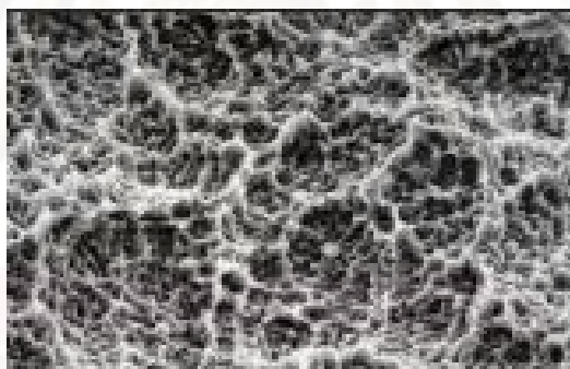
ภาพที่ 9 ความขรุขระบนผิวรากเทียมที่เกิดจากกระบวนการทำ SLA
