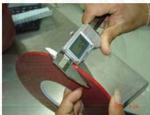
รูปที่ 1.10 การกำหนดจุดวัดและวิธีการวัดขนาดหน้ากว้าง (Width) ของเทปโฟมอะคริลิกที่ทำการศึกษา
