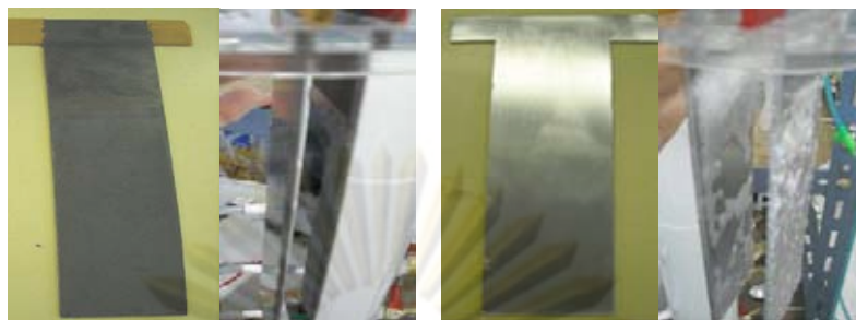
รูปที่ 4-27 ลักษณะขั้วไฟฟ้าก่อนและหลังการทดลอง
