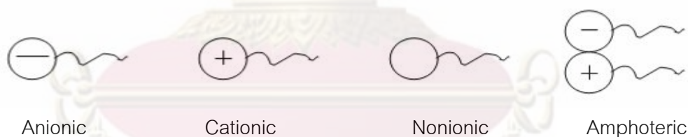
รูปที่ 2-4 ประเภทของสารลดแรงตึงผิวเมื่อแบ่งตามประจุไฟฟ้าของส่วนที่ชอบน้ำ
