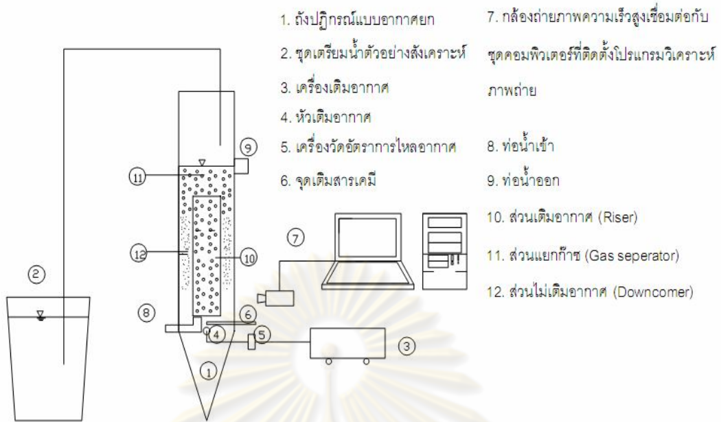
รูปที่ 3.2 แผนผังแสดงการต่อชุดอุปกรณ์การทดลอง
