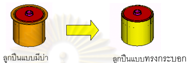
รูปที่ 4.3 การเปลี่ยนแปลงการออกแบบของวัดฤดูติบที่ใช้ในกระบวนการประกอบลูกปืน
