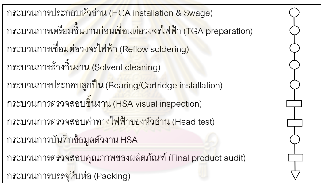
รูปที่ 4.2 Process flow chart ของการประกอบชุดหัวอ่าน
