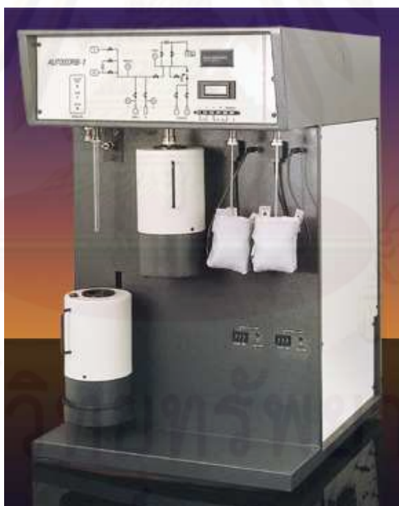
รูปที่ ๑4 เครื่อง Specific Surface Area Analyzer รุ่น Autosorb 1
