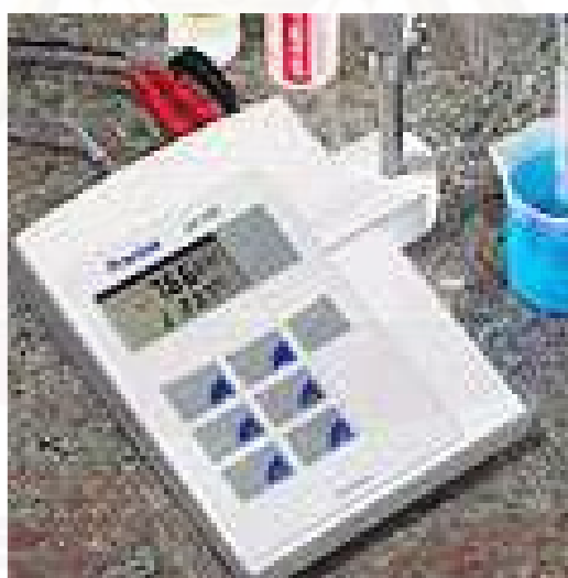
รูปที่ ๑10 เครื่องวัดความเป็น กรด-ด่าง (พีเอชมิเตอร์) รุ่น Precisa pH 900
