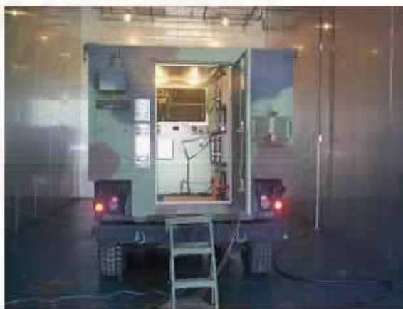
รูปที่ 2.6 ห้องทดลองที่ใช้ทดสอบความเร่งของรถยนต์ที่มีผลต่อการกัดกร่อน (Aberdeen Test Center [ATC], 2002)
