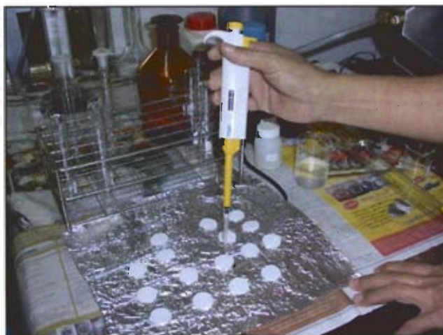
รูปที่ 3.11 การเตรียมสารเคลือบกระดาษกรองของอุปกรณ์ฟอสซีฟ
