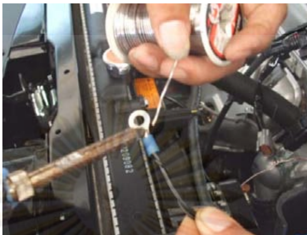
รูปที่ 5.16 จุดปฏิบัติงานในการบัดกรีตะกั่วชุดสายไฟหัวแบตเตอรี่
