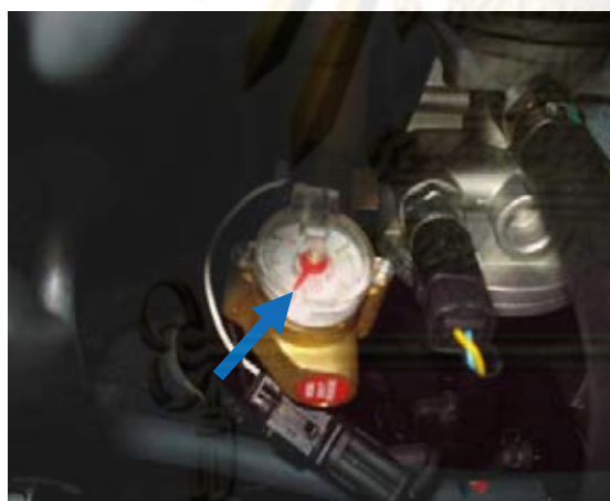
รูปที่ 5.8 ก ระดับก๊าซหลังดับเครื่องยนต์แล้ว
