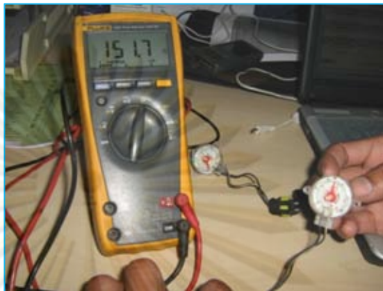
รูปที่ 5.20 การวัดค่าความต้านทานแฉงวงจรของ Pressure Gauge
