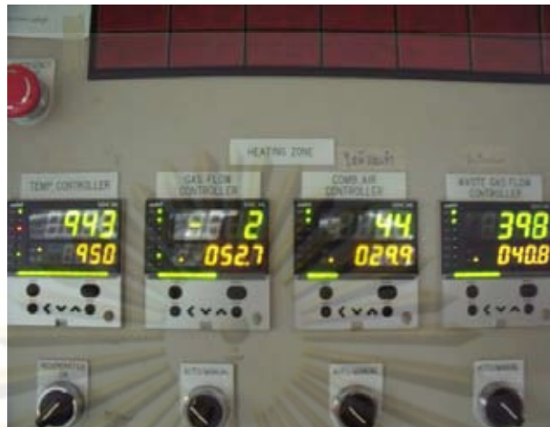
รูปที่ 4.21 คุณหมุ่ภายในเตาเผาในส่วน heating zone (จอซ้ายสุด)
