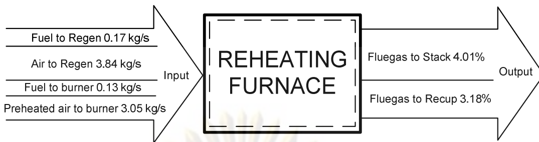
รูปที่ 5.1 Diagram สมดุลมวลของเตา reheating furnace
