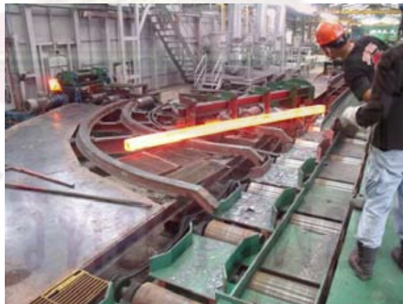
รูปที่ 4.13 Billet ที่ได้จากการอบ(reheating)
