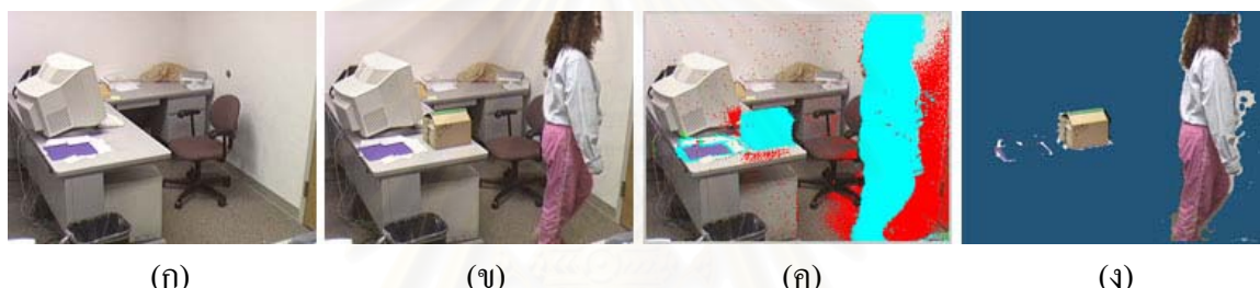
รูปที่ 2.10 ผลการทดลองการจัดการการเปลี่ยนแปลงของฉากหลังของขั้นตอนวิธีที่ใช้เป็นแนวทางหลักในการพัฒนา (ก) แบบจำลองเริ่มต้น (ข) ภาพรับเข้า (ค) หน้ากากการจำแนก (ง) ผลการจำแนก
