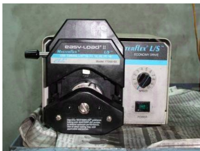
รูปที่ 3.4 ปัมป์ peristatic
