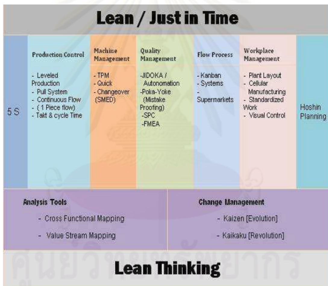
รูปที่ 2.11 ส่วนประกอบของระบบการผลิตแบบลีน
