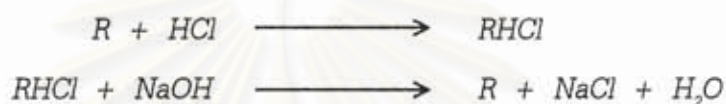
ภาพที่ 2.6 การกำจัดไอออนลบและการทำรีเจนเนอเรชันของเรซินแบบต่างอ่อน (มันลิน ตันจูลเวศน์, 2535)
