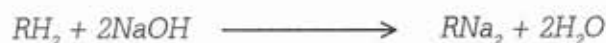
ภาพที่ 2.4 การแลกเปลี่ยนไอออนของเรซินแบบกรดอ่อน (มันลิน ดัณฑุลเวศน์, 2535)
