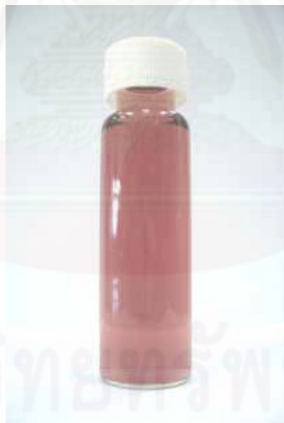
รูปที่ 4.7 ลักษณะและสีของตัวเร่งปฏิกิริยา AuNPs-PVP ที่เตรียมได้
