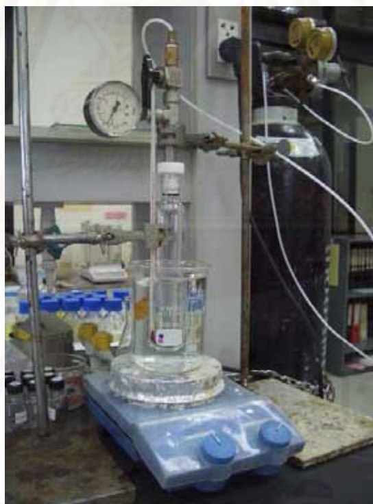
รูปที่ 3.2 การจัดตั้งอุปกรณ์ในการทำปฏิกิริยาออกซิเดชันของกลีเซอรอล
