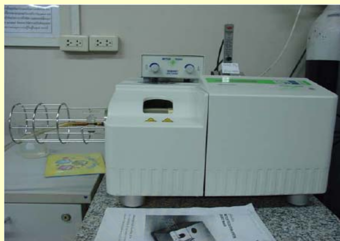
ภาพที่ 3.11 เครื่องเทอร์โมกราวิเมตริกแอนาไลเซอร์ (thermo gravimetric analyzer, TGA)
