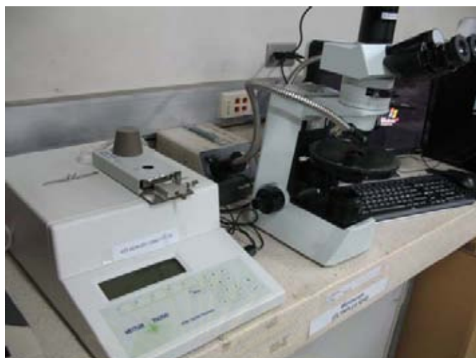
ภาพที่ 3.10 เครื่อง hot stage และ กล้องจุลทรรศน์ (polarized optical microscope)
