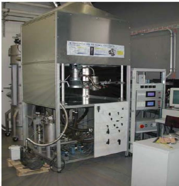
ภาพที่ 2.4 แสดงเครื่องปฏิกรณ์แบบ flame aerosol process
