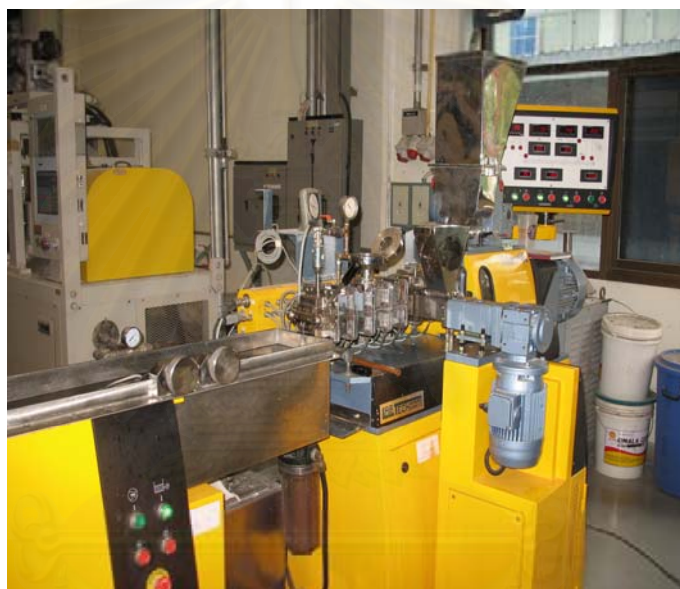
ภาพที่ 3.2 เครื่องอัดรีดเกลียวคู่ (twin screw extruder) แบบป้อนวัตถุดิบสองทาง
