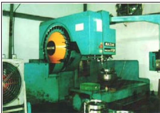
รูปที่ 3.13 ตัวอย่าง เครื่องจักร CNCใช้ในการผลิตผลิตภัณฑ์ FLY WHEEL ในโรงงานตัวอย่าง
