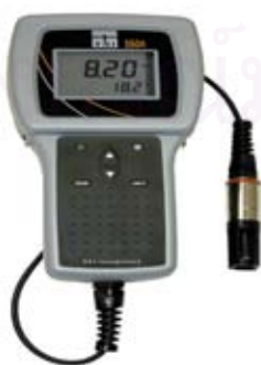
รูปที่ 22. เครื่องวัดค่าการละลายออกซิเจน (DO meter)
