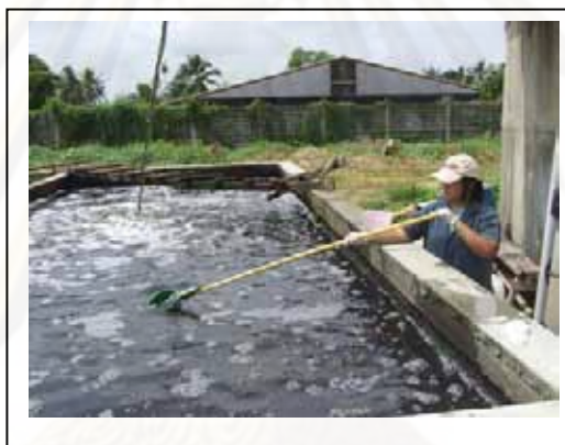
ภาพที่ 3.4 การเก็บน้ำเสียตัวอย่างจากบ่อพักน้ำทิ้ง
