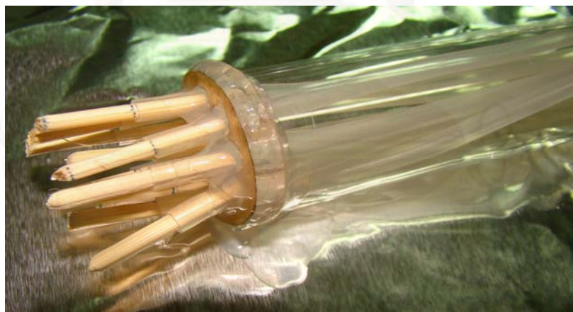
รูปที่ 3.5 สาย PDMS และแผ่นอะครีลิคที่ทำการปิดปลายโดยใช้ซิลิโคน
