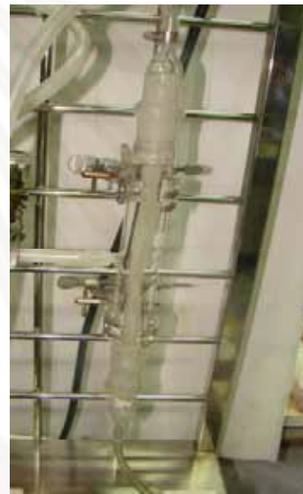
รูปที่ 3.1 แสดงชุดการทดลองการแยกบิวทานอลโดยกระบวนการเพอร์วาพอเรชัน โดยใช้เยื่อแผ่น PDMS แบบหลายท่อ
