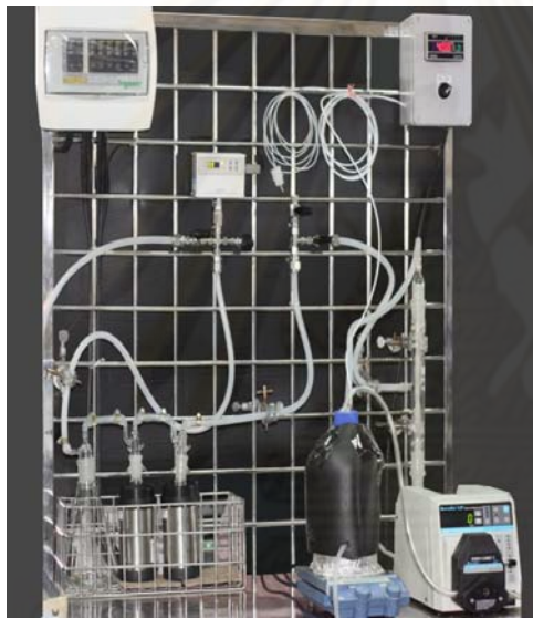
รูปที่ 3.1 แสดงชุดการทดลองการแยกบิวทานอลโดยกระบวนการเพอร์วาพอเรชัน โดยใช้เยื่อแผ่น PDMS แบบหลายท่อ
