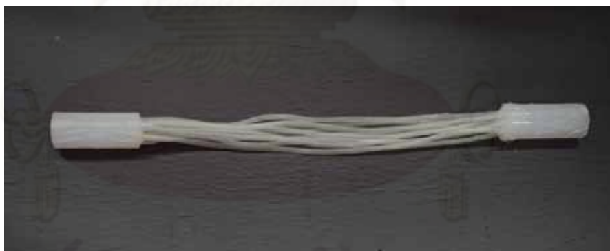
รูปที่ 3.7 เยื่อแผ่น PDMS แบบหลายท่อ
