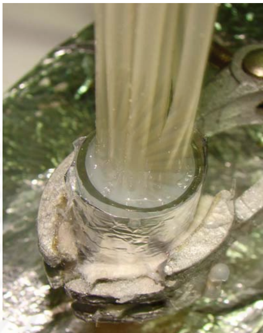
รูปที่ 3.6 สาย PDMS ภายหลังการเติมซิลิโคน
