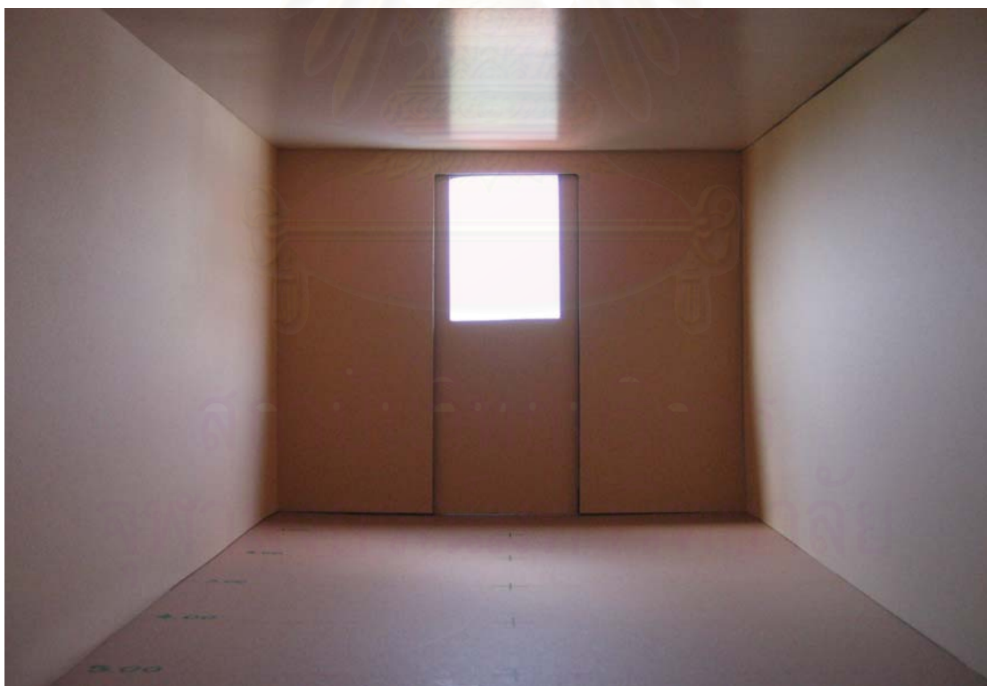
รูปที่ 4-6 การทดสอบระดับความส่องสว่างของช่องเปิด 0.90x1.20 เมตร ที่ตำแหน่งบน
