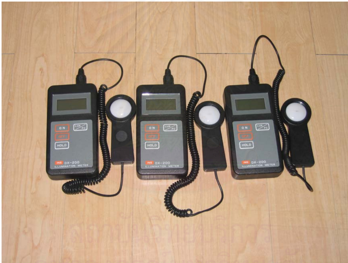
ภาพที่ 3-1 เครื่องมือวัดระดับความส่องสว่าง รุ่น DX-200
