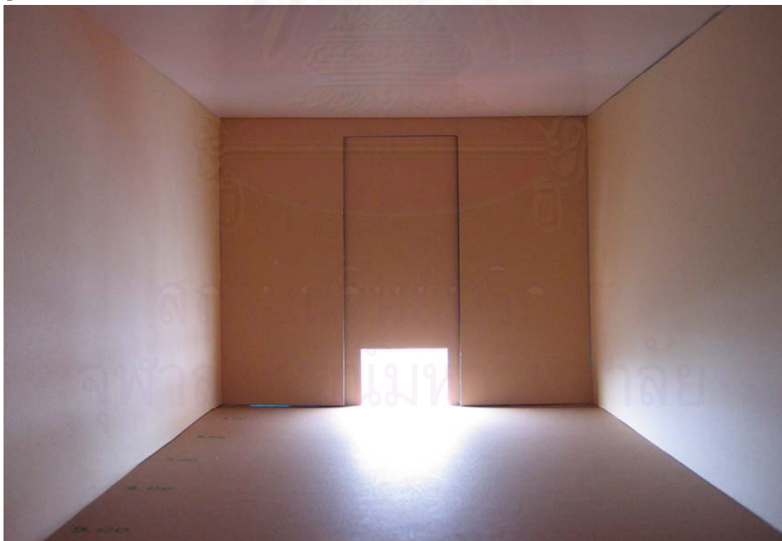
รูปที่ 4-8 การทดสอบระดับความส่องสว่างของช่องเปิด 0.90x0.60 เมตร ที่ตำแหน่งล่าง
