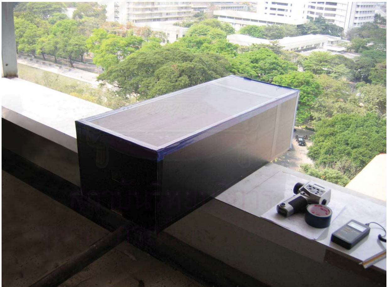
รูปที่ 4-2 เครื่องมือที่ใช้ทดสอบแสงธรรมชาติ
