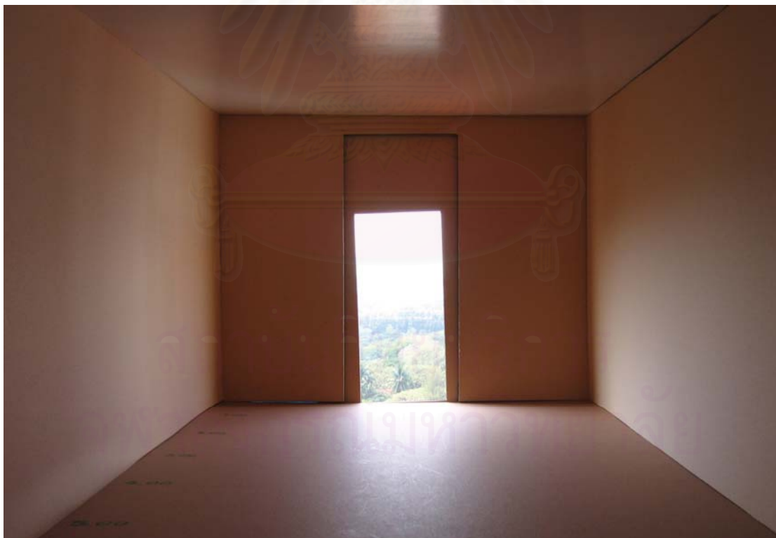
รูปที่ 4-16 การทดสอบระดับความส่องสว่างของช่องเปิด 0.90x2.00 เมตร ที่ตำแหน่งกลาง
