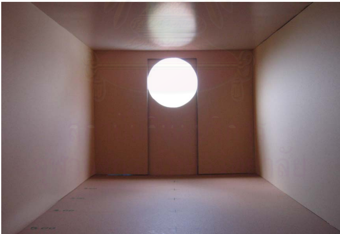
รูปที่ 4-14 การทดสอบระดับความส่องสว่างของช่องเปิดกลม เส้นผ่านศูนย์กลางขนาด 1.20 เมตร ที่ตำแหน่งบน
