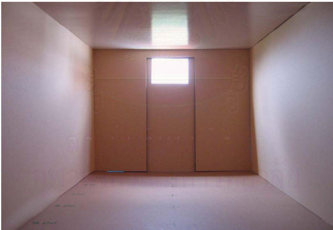
รูปที่ 4-10 การทดสอบระดับความส่องสว่างของช่องเปิด 0.90x0.60 เมตร ที่ตำแหน่งบน
