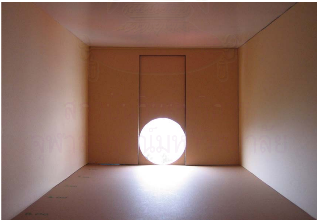
รูปที่ 4-12 การทดสอบระดับความส่องสว่างของช่องเปิดกลม เส้นผ่านศูนย์กลางขนาด 1.20 เมตร ที่ตำแหน่งล่าง
