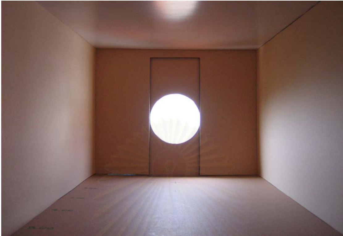
รูปที่ 4-13 การทดสอบระดับความส่องสว่างของช่องเปิดกลม เส้นผ่านศูนย์กลางขนาด 1.20 เมตร ที่ตำแหน่งกลาง
