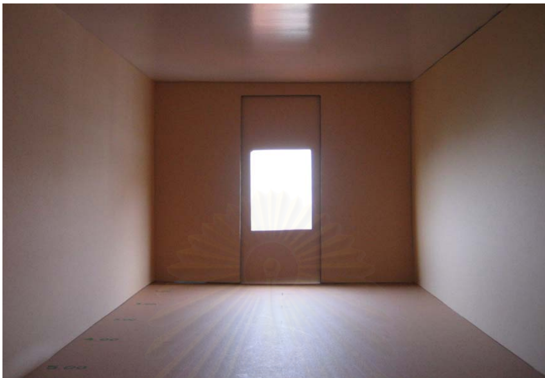
รูปที่ 4-5 การทดสอบระดับความส่องสว่างของช่องเปิด 0.90x1.20 เมตร ที่ยัดตำแหน่งกลาง
