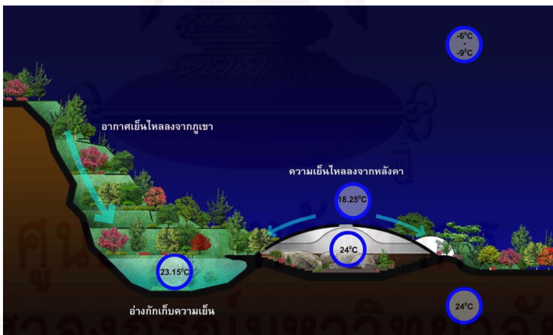
ภาพที่ 4-32 แสดงในเวลากลางคืนอุณหภูมิท้องฟ้าต่ำทำให้ผิวหลังคาภายนอกที่มีค่าการแผ่รังสีความร้อนกลับ (emissivity) สูงและมวลสารน้อยจะมีอุณหภูมิลดต่ำ ทำให้อากาศเย็นบนหลังคาไหลมากักเก็บบริเวณรอบห้องเรียน ผสมกับความเย็นที่ไหลลงมาจากภูเขาในเวลากลางคืน
