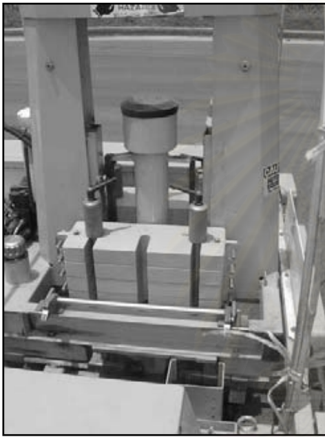
รูปที่ ก-1 เครื่องทดสอบสภาพทางแบบไม่ทำลาย Falling Weight Deflectometer (FWD) (บน) ประกอบด้วยส่วนให้น้ำหนักกระทำ (ล่างซ้าย) และส่วนวัดค่าการแอ่นตัว (ล่างขวา)
