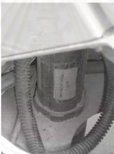
รูปที่ 3.5 เทอร์โมมิเตอร์แบบใช้แสงอินฟราเรดที่ติดตั้งอยู่กับ FWD
