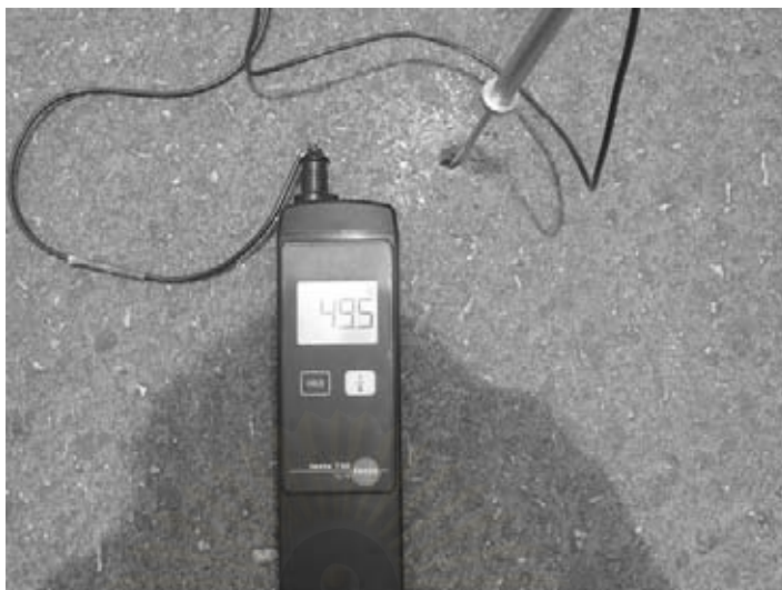
รูปที่ 3.6 การวัดอุณหภูมิที่กึ่งกลางชั้นผิวทางด้วยเทอร์โมมิเตอร์แบบดิจิตอล
