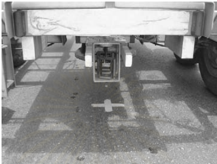
รูปที่ 3.3 การทำสัญลักษณ์ด้วยสีไว้ที่จุดทดสอบ
