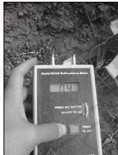
รูปที่ ก-5 ขั้นตอนการติดตั้งเครื่องวัดความชื้นในโครงสร้างทาง และการวัดความชื้นจากเครื่อง Soilmoisture Meter
