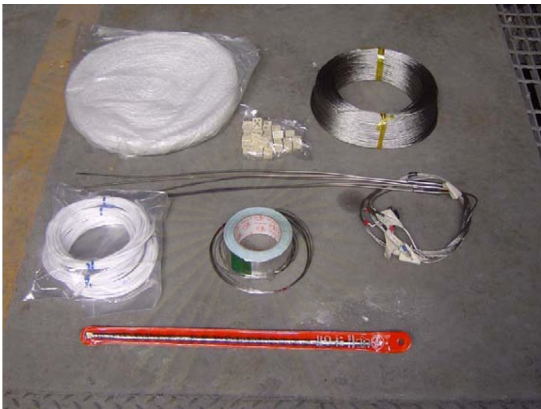
รูปที่ 5.1 ชุดอุปกรณ์วัสดุอนุหภูมิที่จะต้องติดตั้งกับ Regenerator
